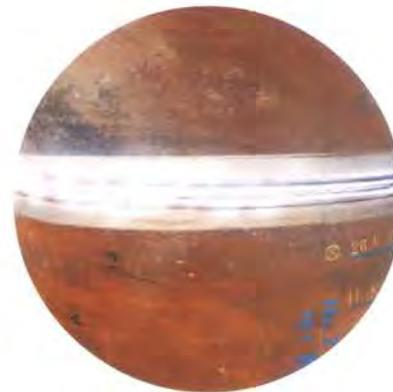
鋼管杭溶接部の浸透探傷検査
