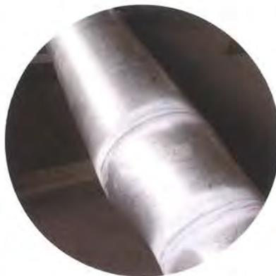
配管溶接部の浸透探傷検査
