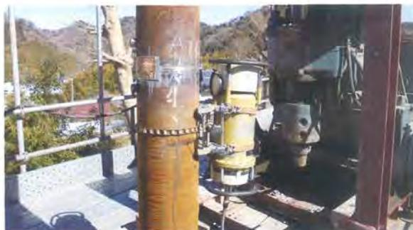
鋼管杭の放射線透過試験
